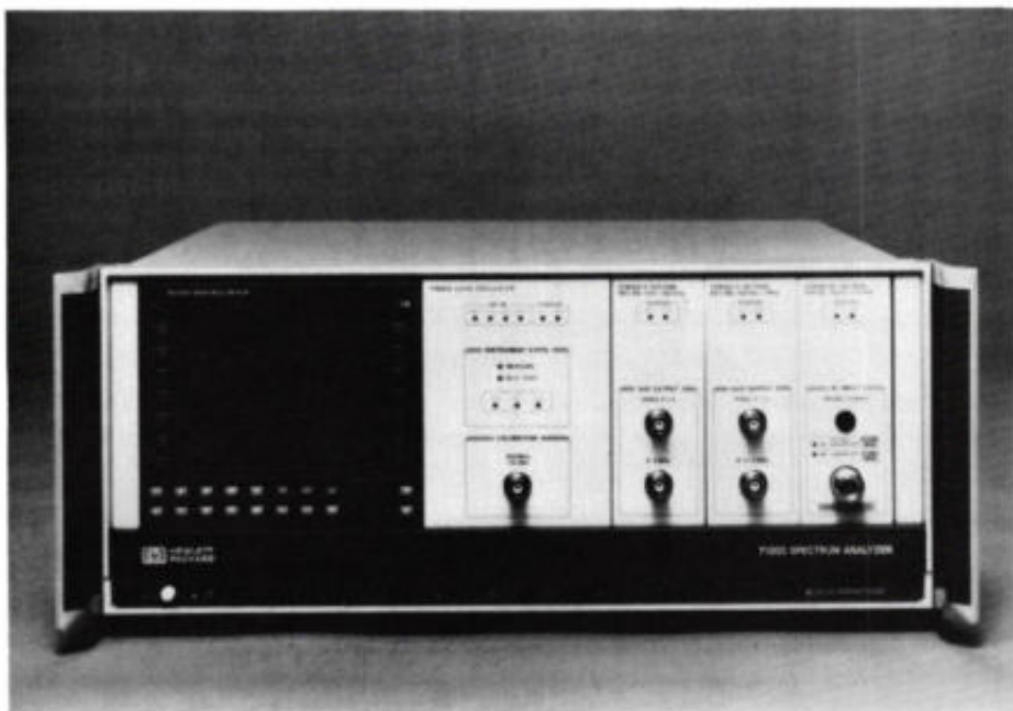
Hoogfrequent-analysator HP71001A, bestaande uit een moederbehuizing met een beeldscherm-eenheid, een lokale oscillator, twee MF-secties en de HF-sectie 70904A, goed voor een frequentiebereik van 100 Hz ... 2,9 GHz.
