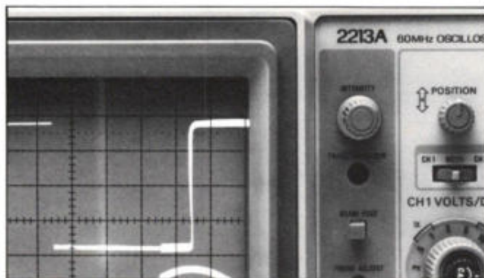
Tek 2213A specificaties: Bandbreedte: 60 MHz Stijgtijd: 5,8 ns Gevoeligheid: 2 mV/div. Aantal kanalen: 2 Delayed Sweep Intensified Sweep (A) Gewicht: slechts 6,1 kg Garantie: 3 jaar
